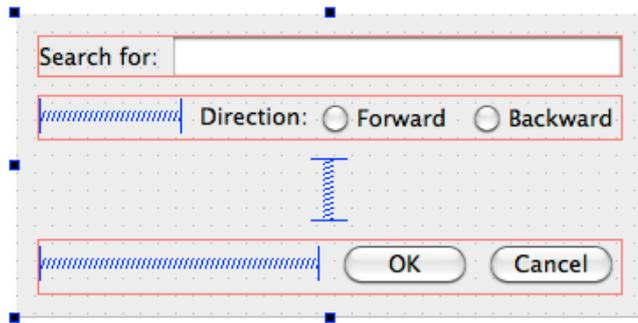
Y pulsando en el cuadro azul inferior derecho de la selección del formulario, haz el tamaño lo mínimo que se pueda de alto, pero hazlo al menos el doble de ancho que de alto, de manera que se parezca al dibujo original. Cambia el nombre del QLineEdit por "searchText" y el de los radiobuttons por "directionForward" y "directionBackward" respectivamente.
