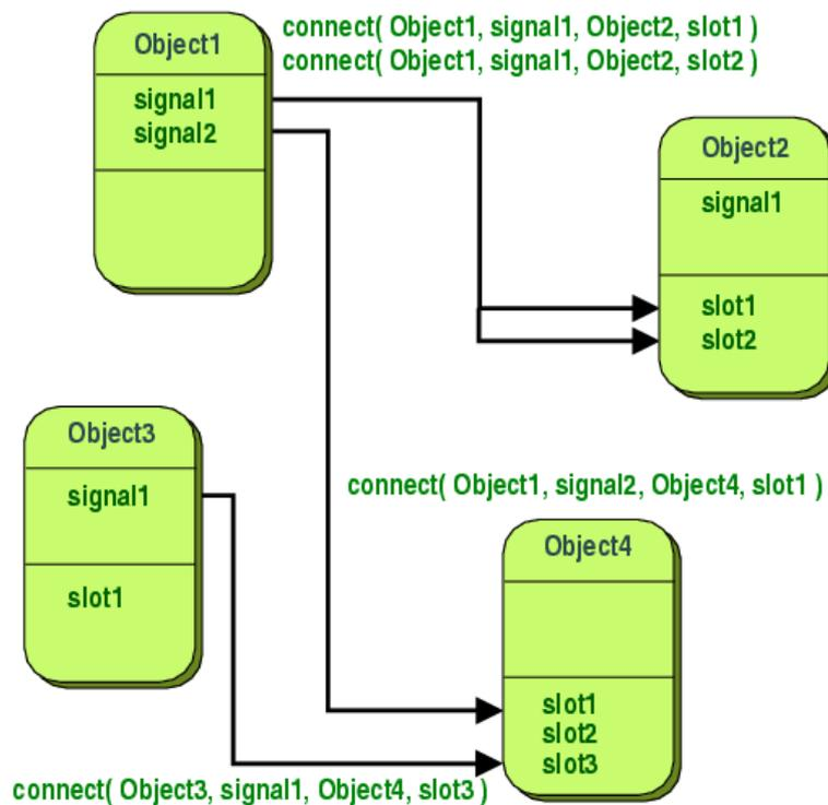
Como se puede ver en el gráfico superior, una señal puede conectarse a más de un slot, para llevar a cabo diferentes actividades. También varias señales diferentes pueden conectarse con un mismo slot, y tendríamos una actividad que puede ser desatada de varias formas diferentes.
